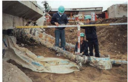
[測定結果]沈下量: 930mm、伸縮量: 350mm (伸び方向)
