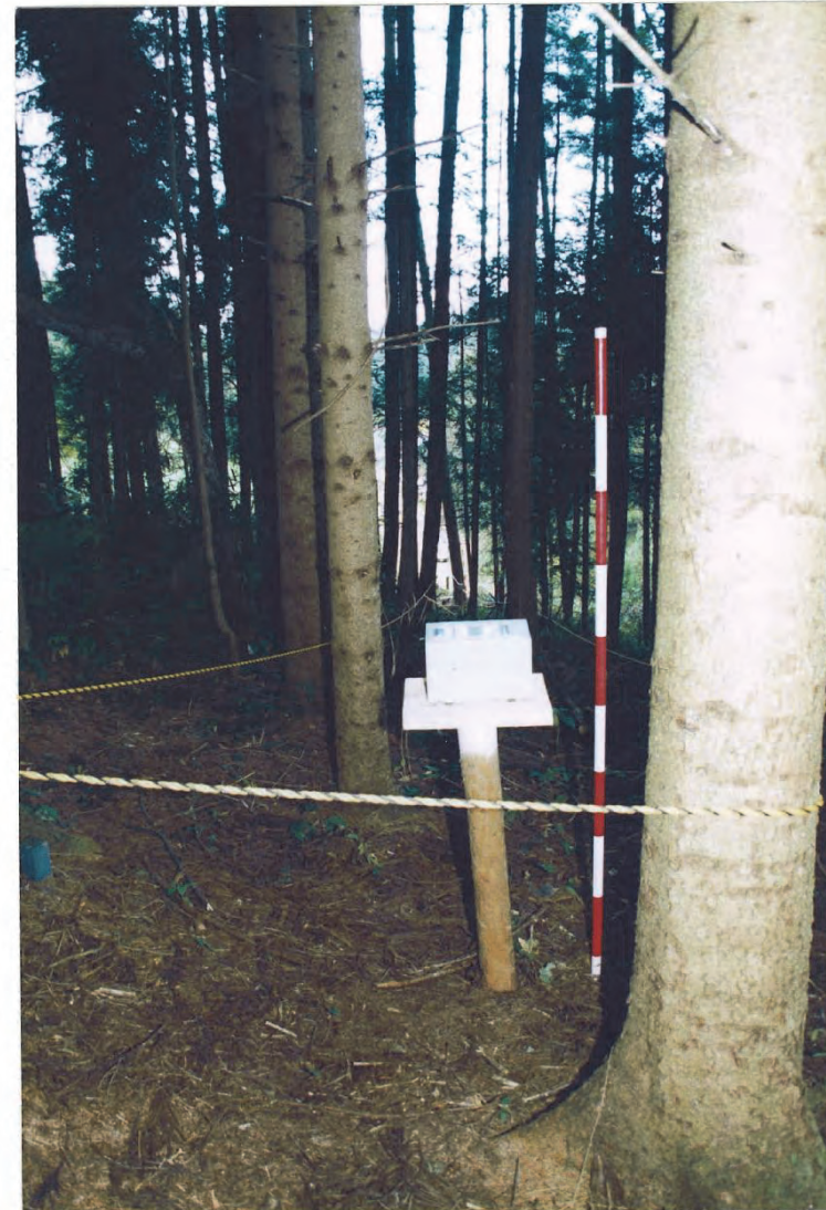
地表部の変位計測(伸縮計)
